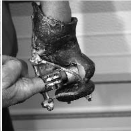
Reduktionsprinzip: Ebenfalls direkte Anlenkung des nach oben gedrehten Kupplungshebels, aber viel weniger Metall und dadurch weniger Gewicht.
