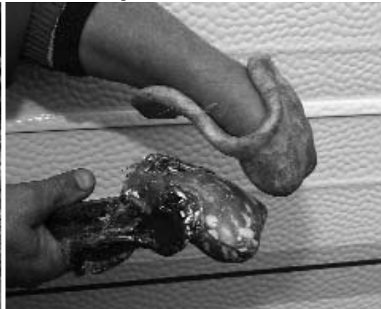
Formenbau: Hier ist die Form (unten) der aktuellen Handschale (oben) zu sehen, über welche die Polyester-matten laminiert werden. Darin steckt viel Kleinarbeit!
