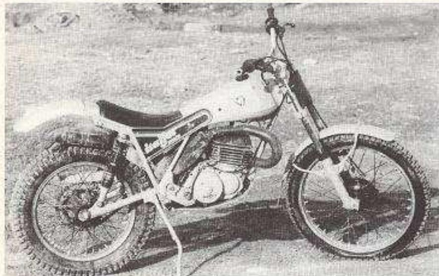
nach vorne nehme, drücke ich automatisch auf die Bremse. Das Gas geht hart. Die Gabel ist ausgezeichnet, dämpft sowohl beim Aus- wie beim Einfedern sehr gut und neigt nicht zum Hüpfen."
