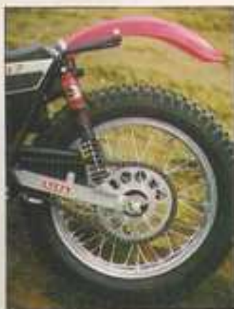
DG 7. Tren trasero: amortiguadores Telesco y 115 mm. de recorrido.
