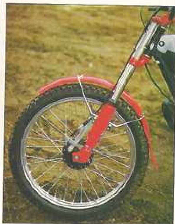
DG 7. Tren delantero: horquilla Betor, barras de 35, y 170 mm. de recorrido.
