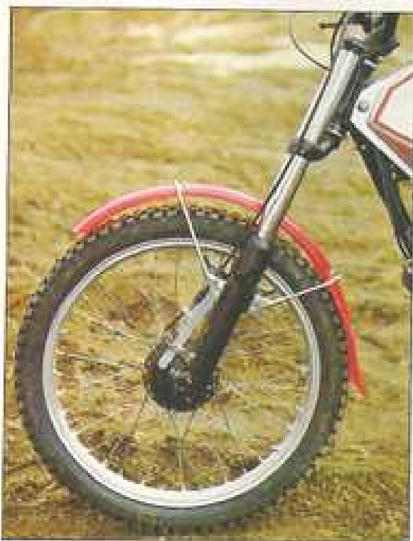
DG 3. Tren delantero: horquilla Betor, barras de 36, y 173 mm. de recorrido.
