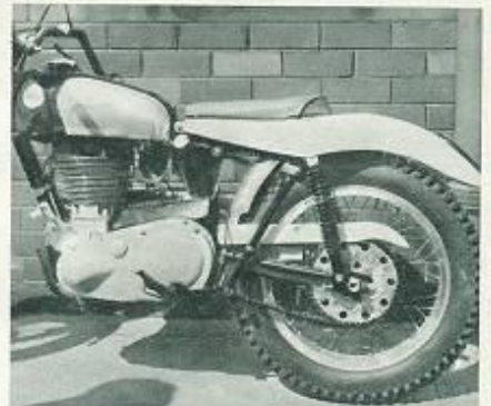
Das Hinterteil von Sammy Millers Maschine. Außer den Kotflügeln sind sowohl der hintere Kettenschutz wie der gesamte Primär-Kettenkasten aus Kunststoff. Ist das Hinterteil nicht Blatt gemacht, die Form war Sammys eigene Handarbeit!
